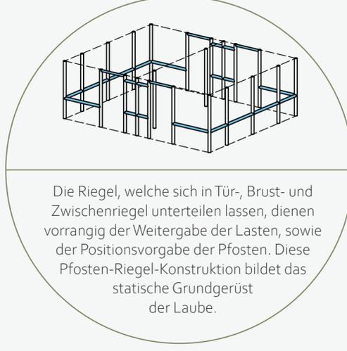
Um die Erhaltung der Lauben zu gewährleisten, ist es wichtig beschädigte Bauteile zu reparieren und vorbeugend die Laube vor Schäden zu schützen.
